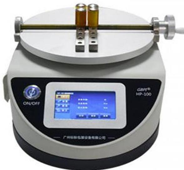
Прибор разработан для измерения моментов закручивания и откручивания бутылочных крышек для фармацевтической упаковки. В сочетании с тестером утечки он может измерять герметичность флаконов с лекарствами.
